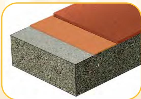
**Piso antideslizante para zonas húmedas Sikafloor® 263 SL en un espesor de 0,6 - 0,8 mm.**
