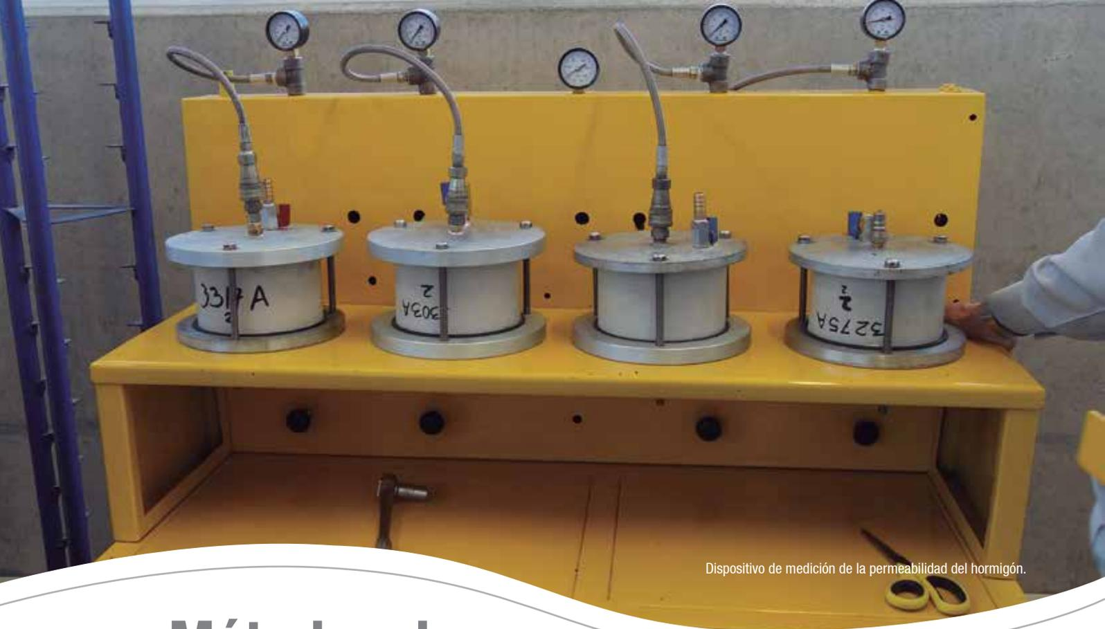
Dispositivo de medición de la permeabilidad del hormigón.
