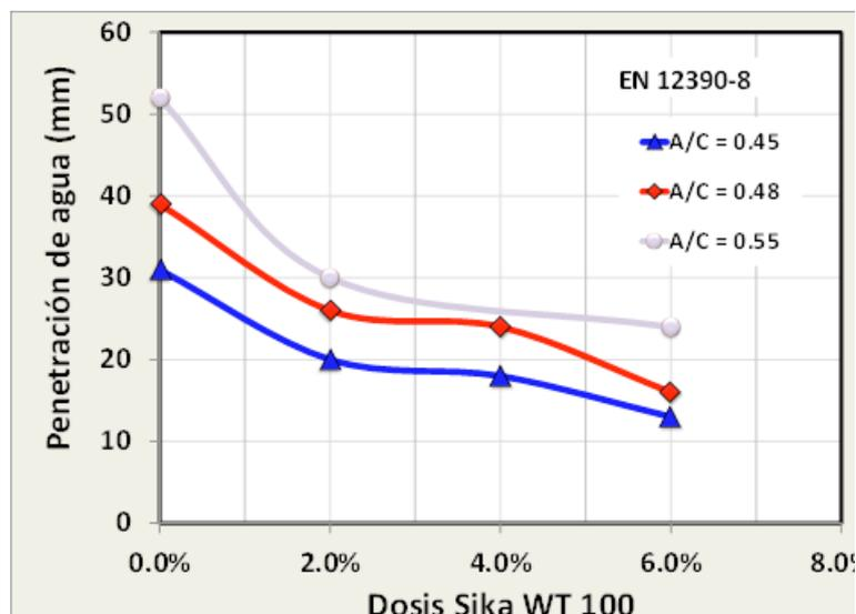
Figura 15. Efecto del aditivo **Sika WT-100** para diferentes relaciones A/C y diferentes dosificaciones frente a la penetración de agua de acuerdo con la norma EN 12390-8
