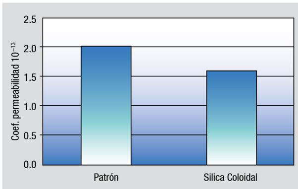
**Figura 10.** Efecto de la adición de silica coloidal en un hormigón con un coeficiente de permeabilidad de  $1 \times 10^{-13}$  m/s
