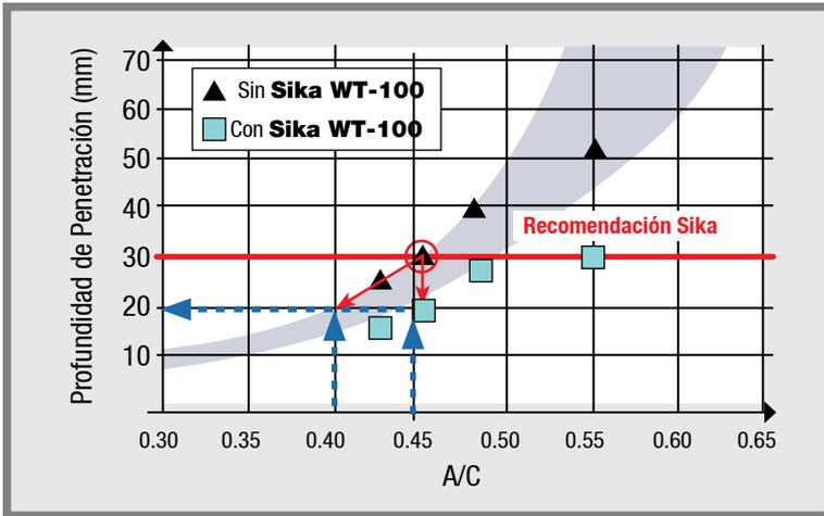
Figura 14. Resultados de Penetración de Agua vs. A/C superpuestos a resultados recientes LEM-Sika con y sin Sika WT100<sup>[18]</sup>.
