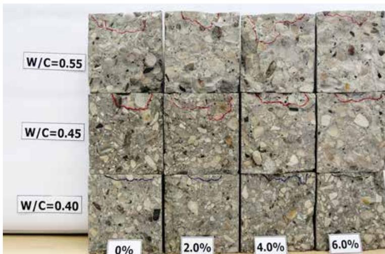
Figura 18. Efecto de **Sika WT-100** sobre la penetración de agua.
