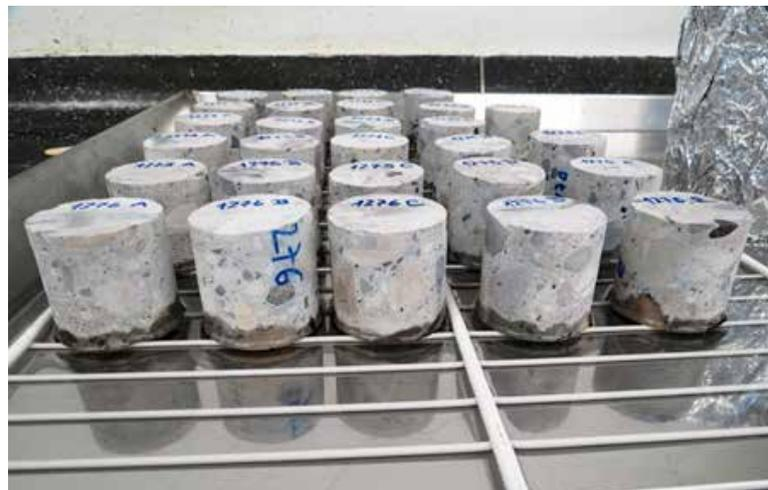
Figura 17. Ensayo de absorción capilar de hormigón de acuerdo con la norma SIA 262–Anexo A.
