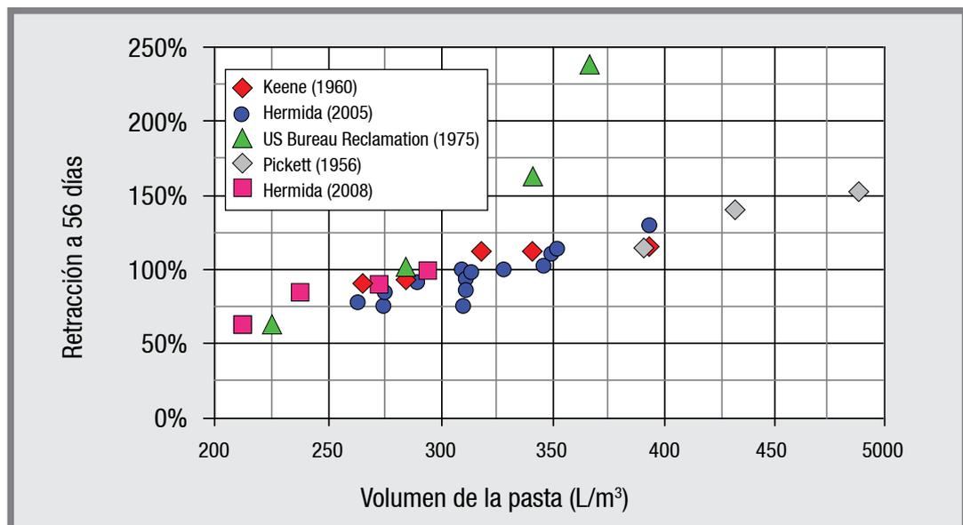
Figura 19. Relación entre el volumen de pasta y la retracción del hormigón<sup>[19]</sup>.
