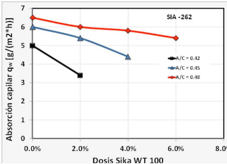
Figura 16. Efecto del aditivo **Sika WT-100** para diferentes relaciones A/C y diferentes dosificaciones, frente a la penetración de agua por absorción capilar de acuerdo con la norma EN 262– Anexo A.
