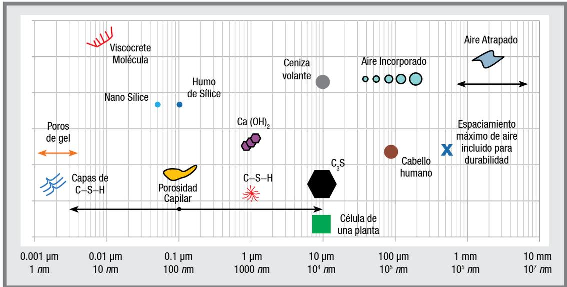
Figura 2. Escala de los poros en el hormigón después de Mehta y Monteiro.
