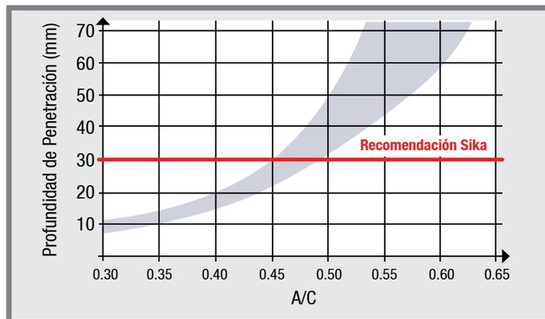
Figura 13. Relación entre la penetración de agua (mm) y la relación A/C de acuerdo con la norma EN 12390-8<sup>[17]</sup>
