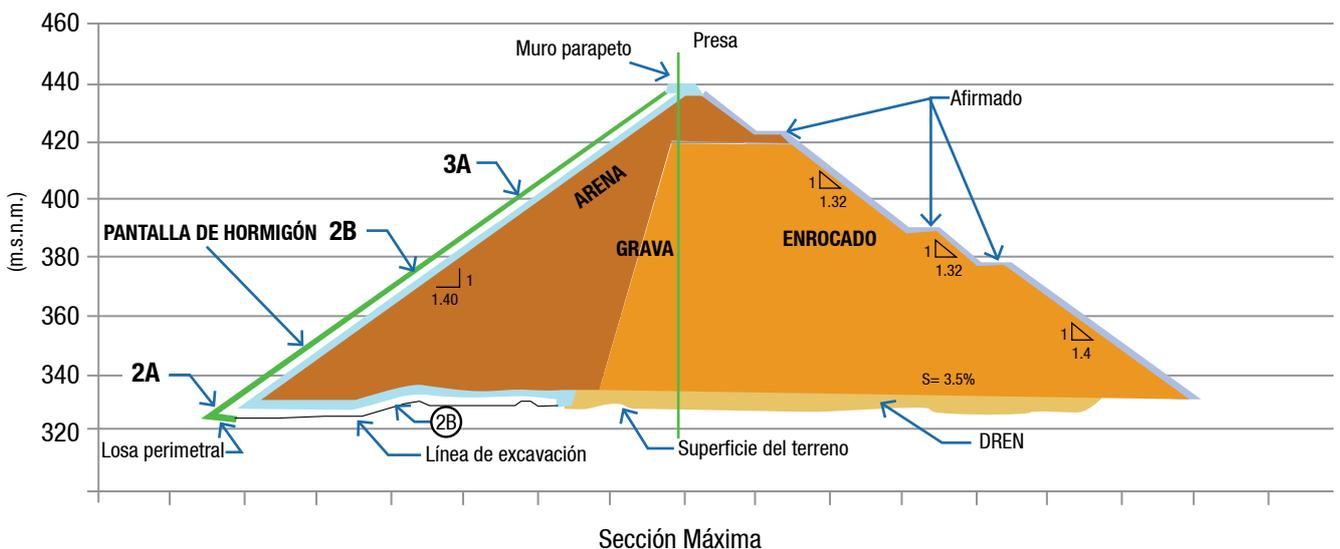
Figura 3. Esquema de una presa de enrocado y pantalla de hormigón (CFRD).
