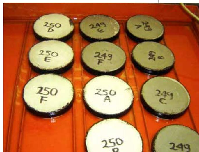
**Figura 12.** Especímenes de mortero semisumergido con y sin Sika 1 al cabo de 4 horas de ascensión capilar.
