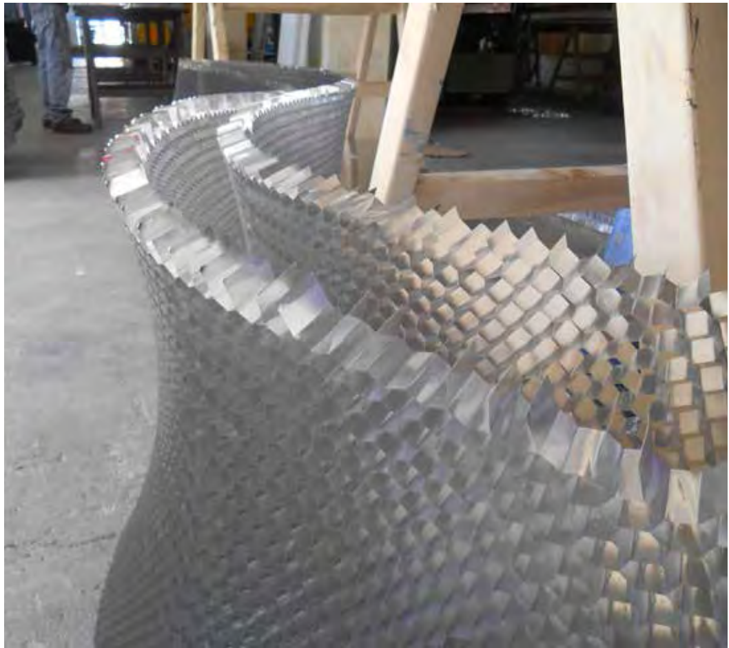
Los paneles de nido de abeja se pueden instalar en grandes dimensiones, tienen una excelente rigidez, son planos y reducen el peso de la estructura.
