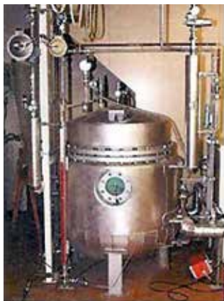
Esquema del dispositivo de presión con especímenes de prueba arreglados de forma vertical en agua con oxígeno enriquecido.
