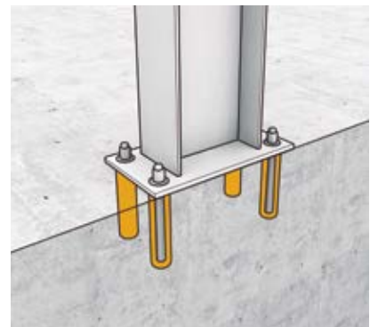
Anclajes en pilares
