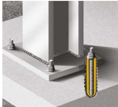
Anclajes estructurales, bases metálicas y columnas
