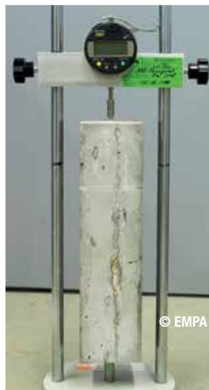
**El aumento en el volumen debido a la presión resultante de la RAS se hace perceptible mediante la medición del cambio de longitud en una probeta de ensayo. Normalmente las muestras se almacenan en condiciones intensificadas (temperatura, humedad, carga aplicada) para acelerar la reacción.**
