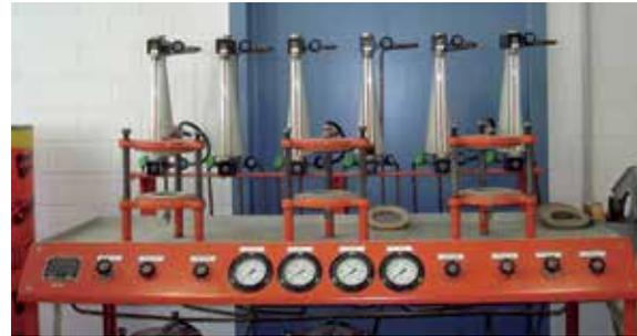
**Impermeabilidad del hormigón al agua bajo presión, mide la penetración máxima de agua en mm después de un periodo definido con una presión especificada (24 horas con 4 bar, de acuerdo con EN12390-8)**
