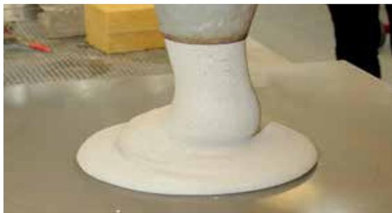
**La resistencia a compresión sobre 150 MPa, ya no es una cuestión de hormigón común. Los áridos de rocas se reemplazan por ejemplo por áridos finos de origen cerámico y toda la matriz aglomerante solamente es una pequeña reminiscencia del hormigón clásico. La ilustración muestra el comportamiento del flujo de un HUAR de 200 MPa.**
