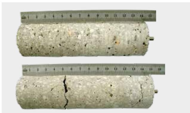
Deterioro del hormigón debido al ataque de sulfatos antes y después del ensayo. Se muestra un fuerte aumento en la longitud. Las primeras grietas han aparecido en la muestra.
