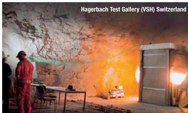
En hornos con cámaras especiales se puede replicar la trayectoria de un incendio ensayando y evaluando paneles. El desarrollo de la temperatura se mide a distintas profundidades.
