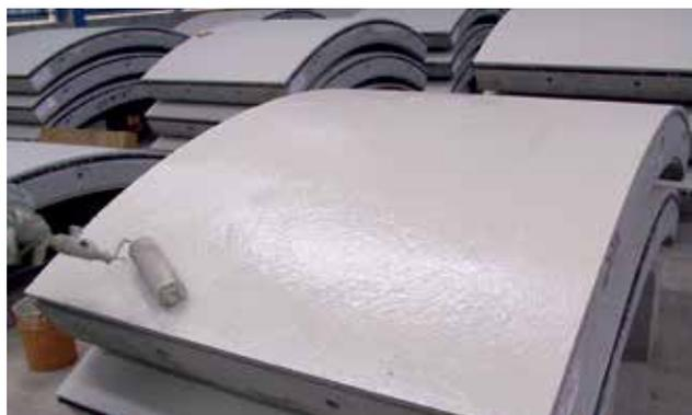
Inmediatamente después del curado a vapor, la superficie de hormigón de los segmentos para revestimiento de túneles se cubre con una emulsión epóxica de base acuosa, que se absorbe incluso por los poros más pequeños generando una capa protectora de sellado.
