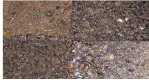
**Ensayos de exposición al fuego de hormigones que tienen distintos áridos. La superficie se desprende y sinteriza, por lo que se puede comparar un rango de desarrollo de temperatura a distintas profundidades.**
