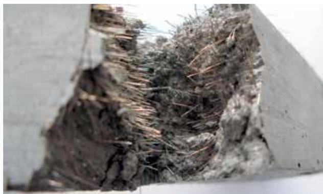
El hormigón de alta resistencia y sobre toda el de ultra alta resistencia son prácticamente siempre reforzados con fibras. Dependiendo de los requerimientos, las fibras sintéticas y/o de acero se emplean en gran cantidad. La alta resistencia a la flexión del hormigón de ultra alta resistencia se puede lograr de este modo.
