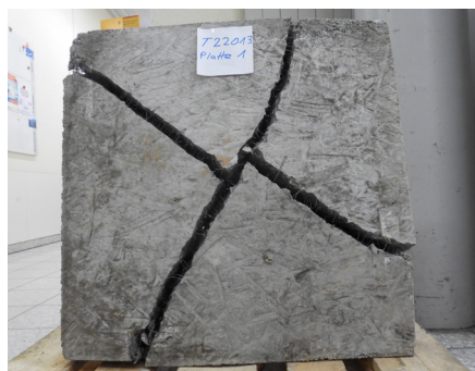
Figura 8.2.1.2: Vista inferior de los paneles cuadrados probados
