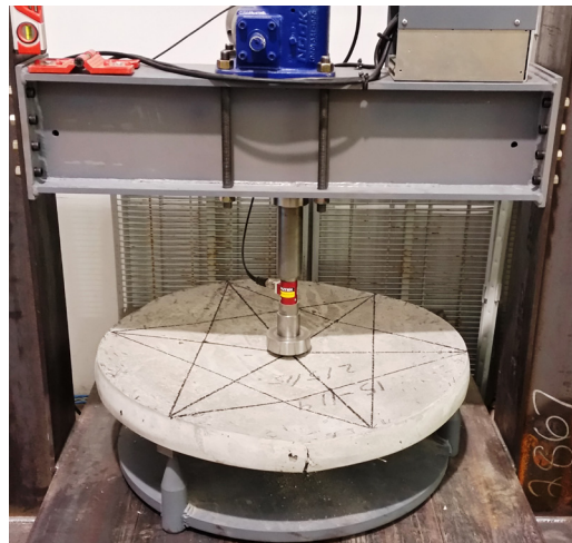
Figura 8.2.2.1: Método de prueba estándar para la tenacidad a la flexión de FRC
