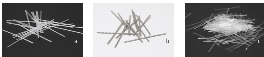
Figura 5.3.1: a) Fibras relieve rectas b) Fibras onduladas c) Fibras planas blandas
