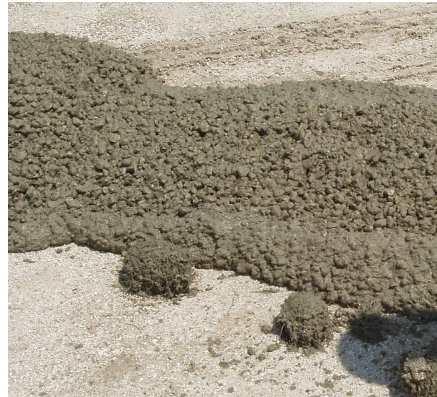
4.1.2: Concreto fresco con formación de bolas
