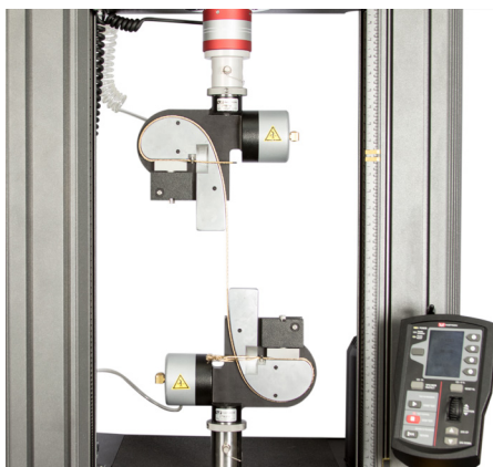
Figure 4.4.1.2: Ensayo referido a ASTM D2256 D2
