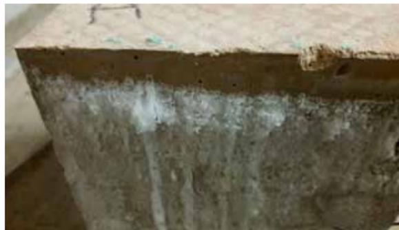
Experimento en laboratorio con Sika® WT-200P, muestra el crecimiento de cristales visibles para el ojo humano.
