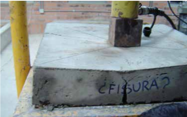
Ensayo EFNARC para determinar la absorción de energía en hormigón lanzado. EN (14488-5) ver normas actuales que rigen el empleo de las fibras pág.22
