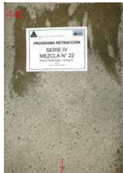
Figura 3. Hormigón 4000 psi a las 24 hrs con SikaFiber®AD, expuesto a viento de 2 m/s
