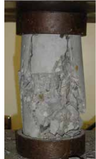
Falla de hormigón de ultra-alta resistencia, con fibras
