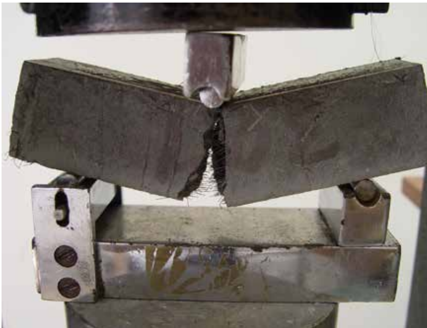
Prueba a la flexión de hormigón con fibras para un Módulo de Ruptura de 200 \text{ kg/cm}^2 .
