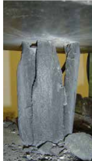
Falla de hormigón de ultra-alta resistencia, sin fibras
