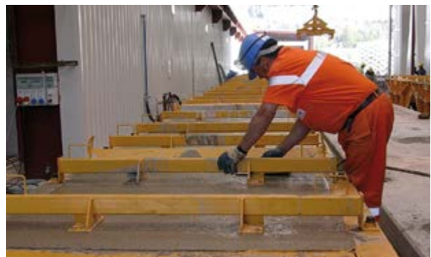
Foto 27.- Fratasado de dovela base. Acopio de dovelas
