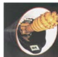
Figura 48.- Escudo excavador y esquema - sección del mismo
