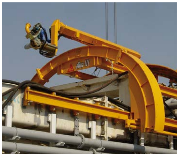
Foto 2.- Detalle de máquina tuneladora y robot de hormigón proyectado
