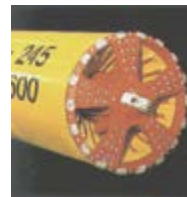
Figura 47.- Detalle Microtuneladora y esquema - sección de la misma
