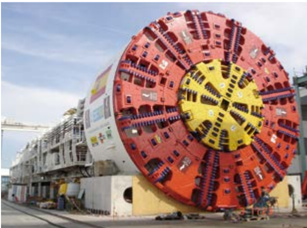
Foto 29.- Detalle de la cabeza de corte de un escudo
