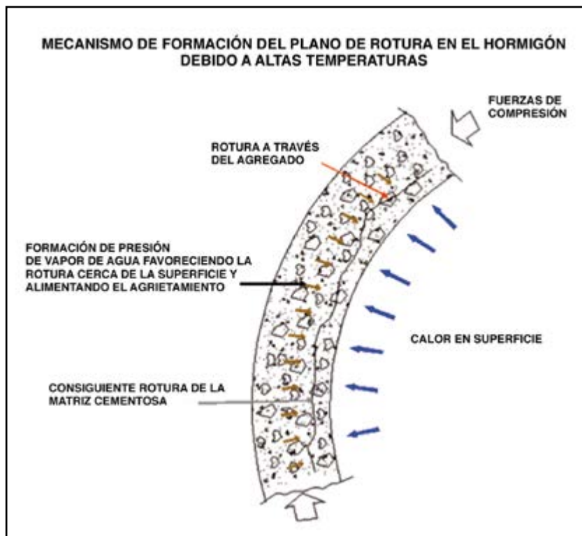
Figura 27.- Esquema del mecanismo de rotura por acción del calor
