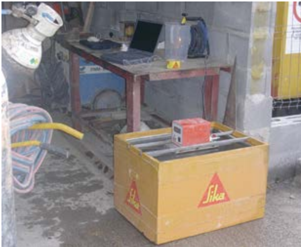
Foto 12.- Detalle del Sistema Sika Adiabático de Inmersión
