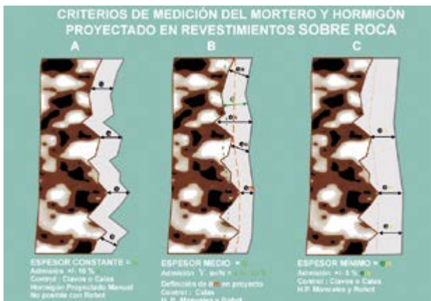
Figura 14.- Criterios de medición de espesores
