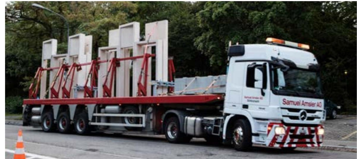
Para transportar los elementos prefabricados desde la fábrica a la obra se contrató una empresa de transportes especiales con plataformas de carga baja para evitar restricciones de altura y problemas con los puentes en la ruta.
