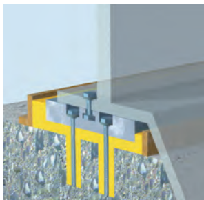
Grouting y anclaje de pernos.
